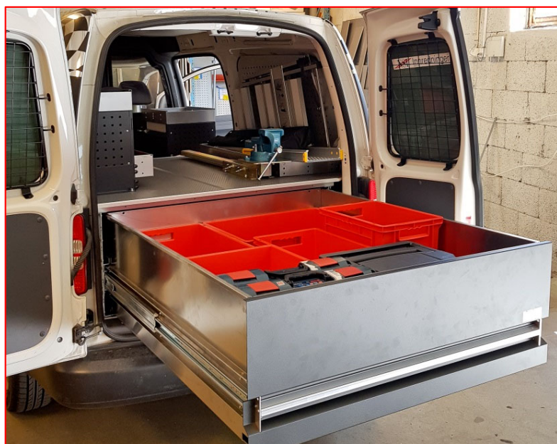
ALULINE UGS type A2 bakover i VW Caddy Maxi (bilde over) - og vanlig gulvhøyde mellom skyvedørene (bilde til venstre). Gir god takhøyde og plass til mye utstyr mellom skyvedørene. Kan evt kombineres med AluLine reoler.
